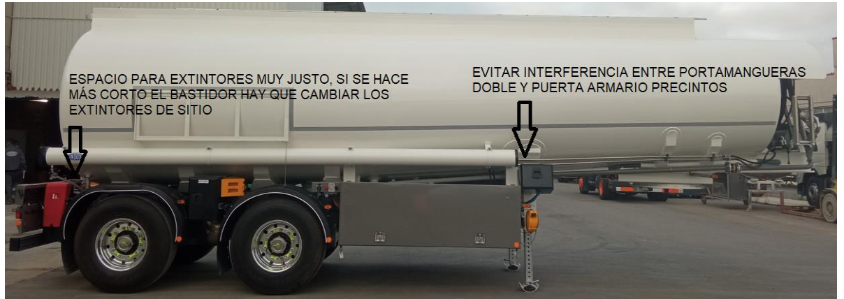
Ilustración 2: Espacio extintores y armario Argos.
